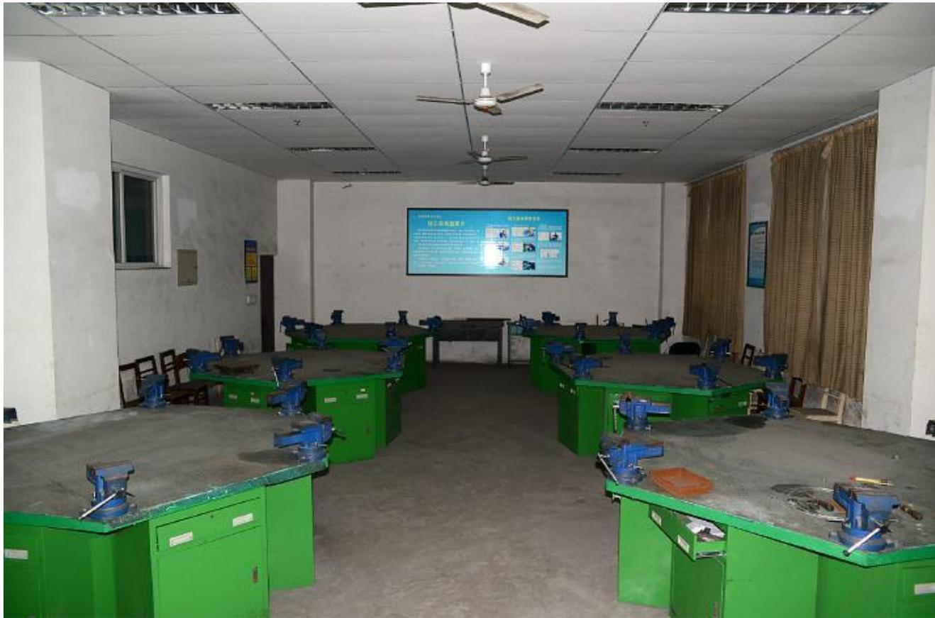
钳工实训基地主要设备有：钳工操作台及台虎钳、砂轮机、台式钻床。钳工实训基地共有实训室4间，面积约有400平方米，可同时容纳140人的钳工技能培训。
